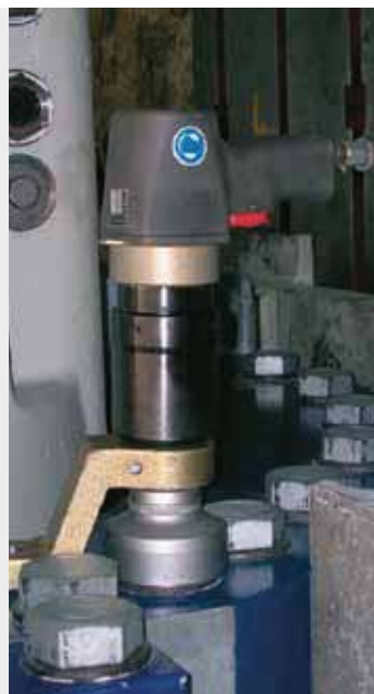
alkitronic® CLD 使用中的倍力板手(如右圖)。 用於大型建築機械柴油機的螺栓連接。
